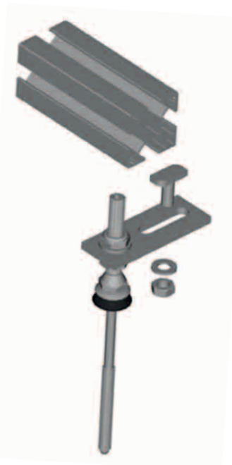
◀ Profilschiene 40 x 40 mm und Solarbefestiger für Wellenernit, mit selbstfurchendem Gewinde, Adapterblech, Hammerkopfschraube, Scheiben und Muttern
