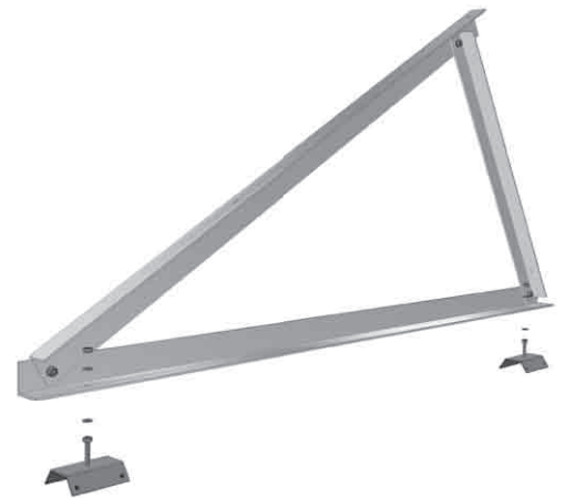
Aufständungswinkel zur Aufbringung auf den Trapezblechschuh
